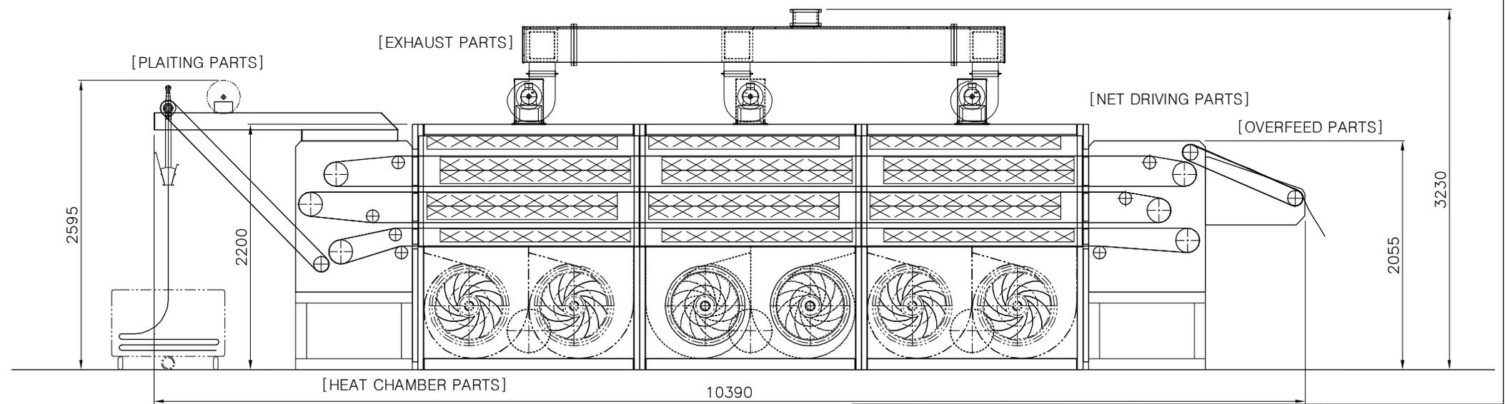
**TENSIONLESS DRYER MODEL : DNTD-2400(3L, 3CH)**
